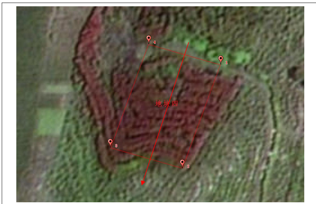
图 3.2.3-1 各地块内地下水流向示意图
