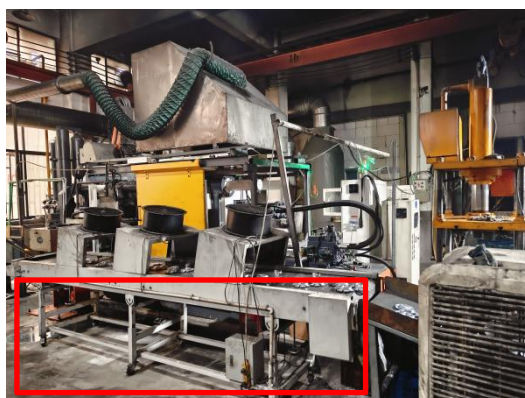
压铸机减振措施（部分）
