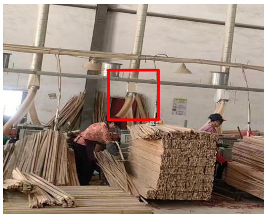
精刨粉尘收集装置（部分）
