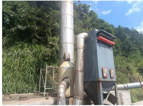
粉碎、制粒、投料、下料废气布袋除尘+水膜除尘器
